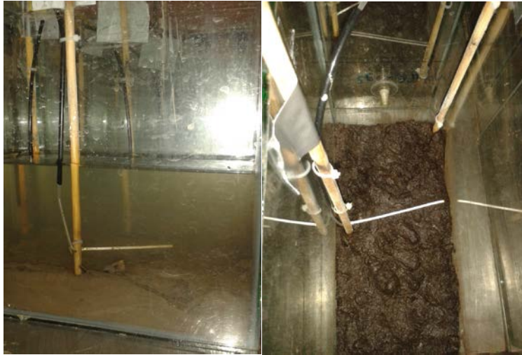
Foto 4 Links: Zijaanzicht van aquarium met klei/veen mengsel met daarop 3 L water. Er zijn per aquarium 2 rhizons aangesloten voor bodemvocht- en watermonsternamen: een in de bodem en een in de waterlaag. De rhizon voor de waterlaag is hier te zien. Rechts: Bovenanzicht van droogval aquarium met een duidelijke veenbodem.
