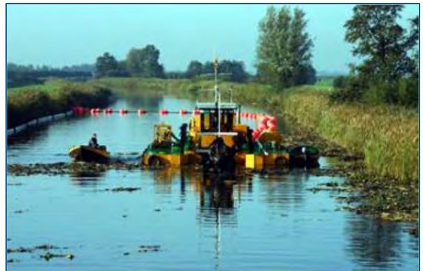
Figuur 2.1: Impressie baggervaartuig met snijkoppen
