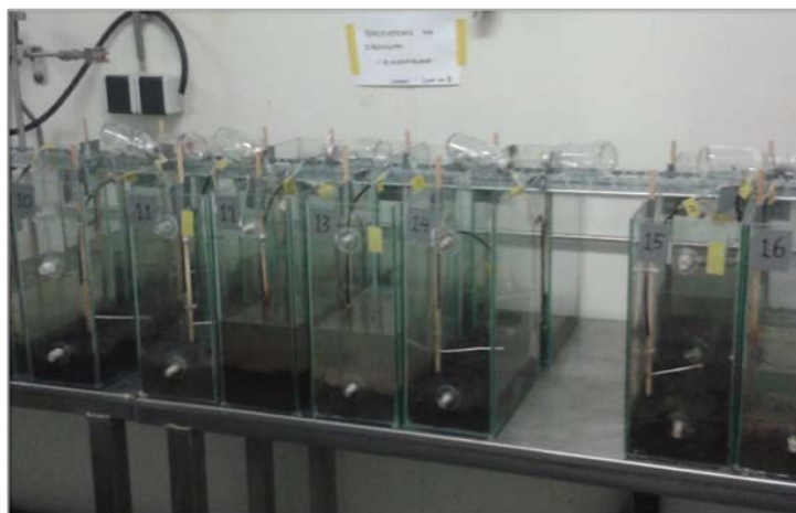
Foto 2 Overzicht van het droogvalexperiment. 16 aquaria zijn gevuld met twee bodem typen uit het Grote of Achterwaterschap: a) veen en b) klei-veen.
