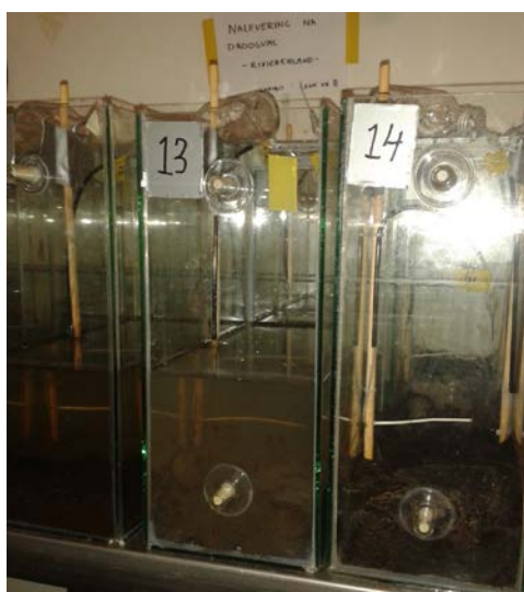
Foto 3 Close-up van twee aquaria met links (nr13) een klei/veenbodem waarboven water staat en rechts (nr14) een veenbodem tijdens droogval.
