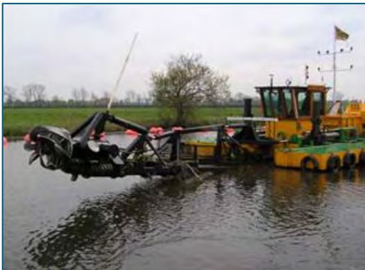
Figuur 2.1: Impressie baggervaartuig met snijkoppen
