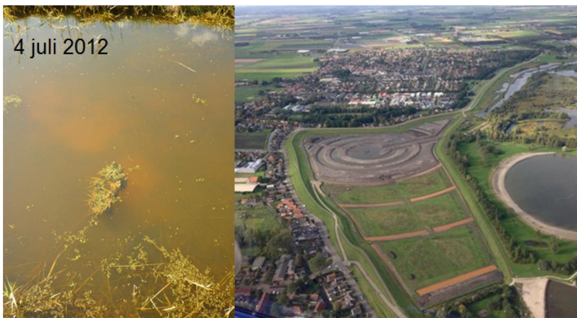
Figuur 3.29 Links een beeld van de watervegetatie in de omliggende sloot (zuidzijde polder) in 2012, en rechts een luchtfoto uit 13 februari 2013. De roestbruine kleur duidt op kwel.
