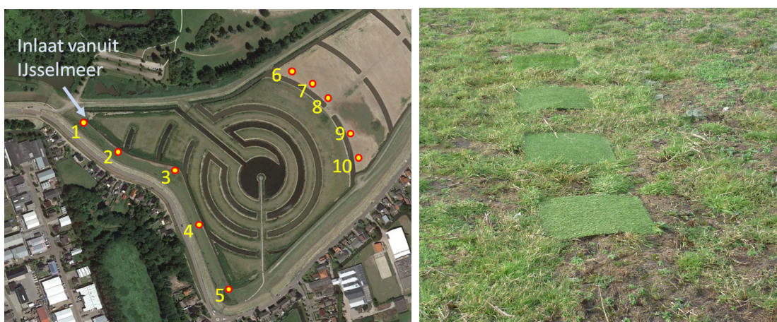
Figuur 2.7 Opzet van meetnet voor slibdepositie voor metingen in 2016, met (a) de 10 meetpunten en (b) een beeld van meetpunt 8 met 5 slibmatten op korte afstand van elkaar.
