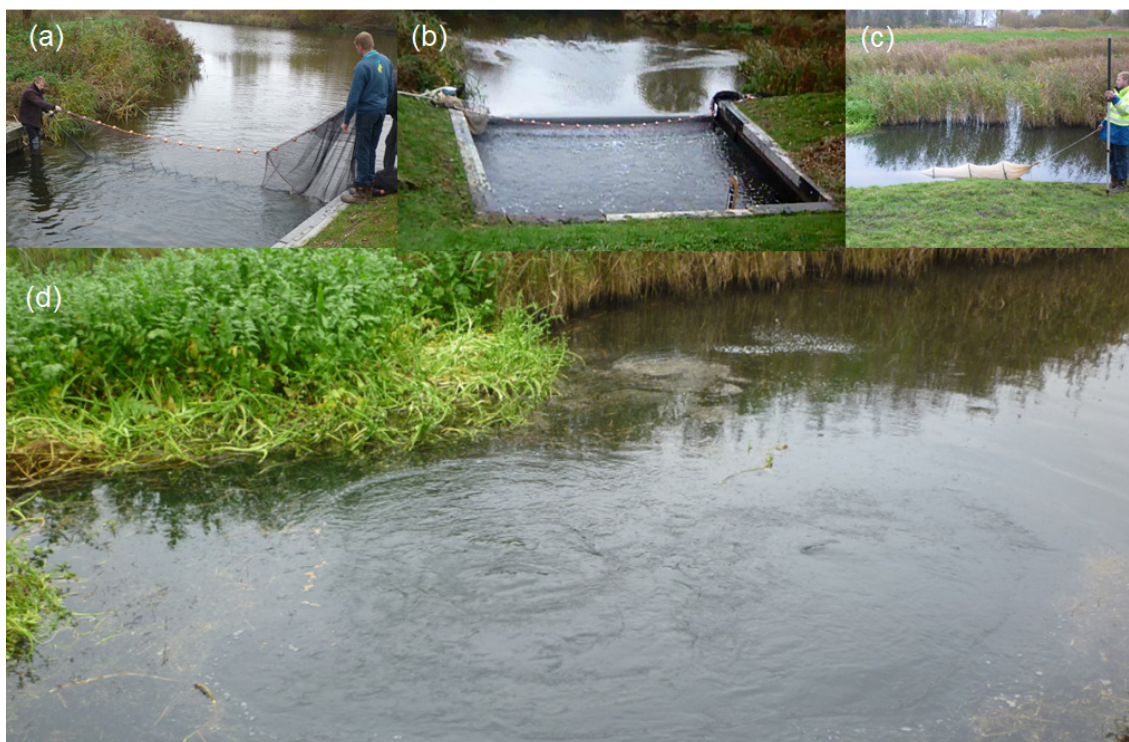
Figuur 3.60 Buisvijzel experiment op 17 november 2014: (a) plaatsen van het net achter de slibvang, (b) IJsselmeerwater wordt ingelaten, (c) en de vis wordt opgevangen met een fuik in de polder, (d) plaats waar het water – en de vis – de polder instroomt.
