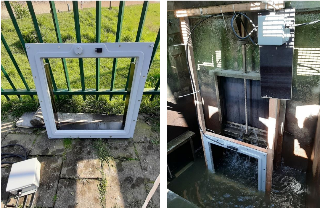
Figuur 9 PIT-antenne zoals deze zijn gebruikt in het onderzoek (links) en geplaatste antenne in de in- en uitstroompout (antenne 2).
