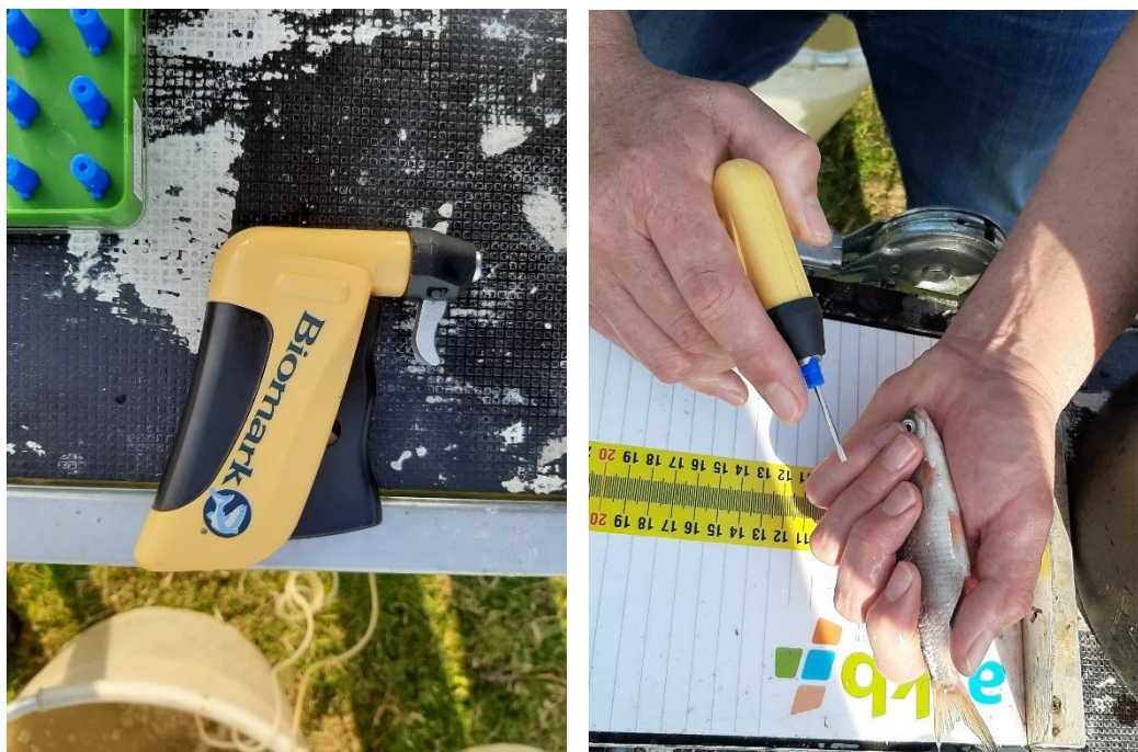
Figuur 7 PIT-tag injector (links) en het inbrengen van een PIT-tag in een verdoofde vis (rechts).
