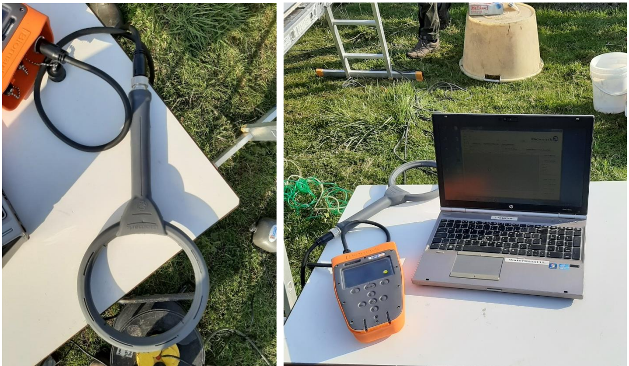
Figuur 6 Handheld-reader om vissen te controleren op de aanwezigheid van een PIT-tag (links) data afkomstig van de reader kan direct worden ingeladen op de laptop (rechts).
