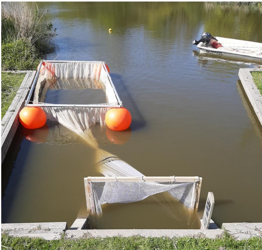
Figuur 12 Opvangnet aan de IJsselmeerzijde waarin de vissen voor de intrekmeting met semi-gedwongen doorvoer werden geplaatst. De foto is genomen voor aanvang van de proef waarbij het netwerk tussen de drijvende bak en de duiker nog niet open is voor vis.
