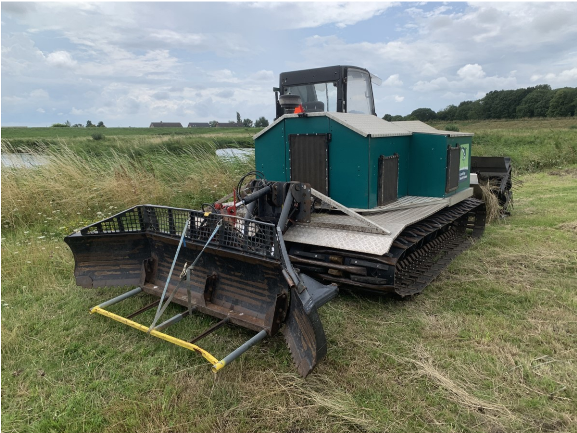
Afbeelding 3.39 Gespecialiseerde maaipaaratuur van Natuurlijke Zaken. Dergelijke maaimachines zijn ook geschikt voor natte percelen met een zachte bodem
