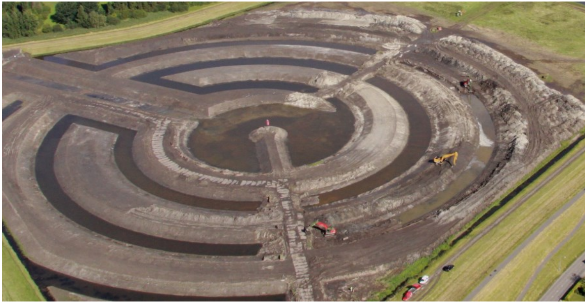
Afbeelding 3.11 Luchtfoto uit 2012 tijdens de constructie van de ringen waarop duidelijk de verschillen in bodemsamenstelling zichtbaar is. Het lichte deel is meer zandig wat zich ook uit in een schrale vegetatie op die plek
