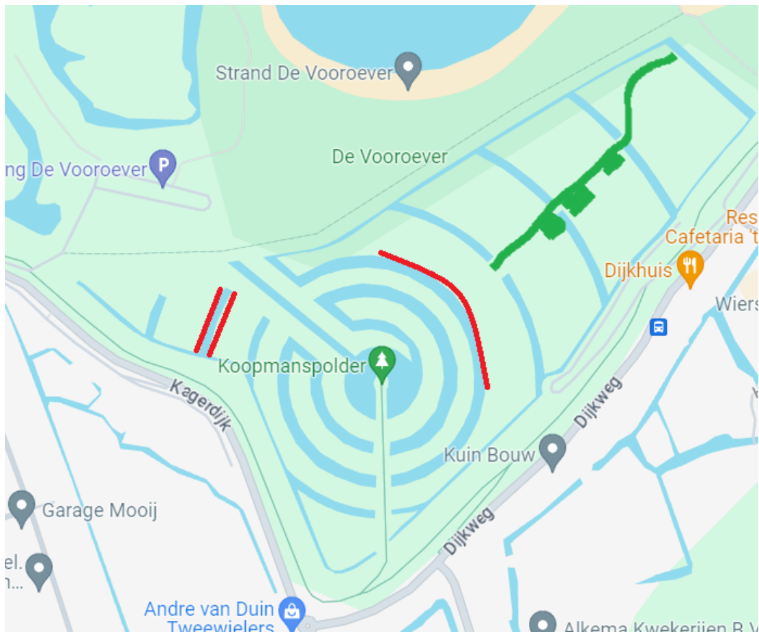
Afbeelding 3.57 Een schetstekening van de diverse maatregelen. In rood de delen waar gepland was om het talud te verflauwen en in groen de delen op de weilanden die zijn opgehoogd (grondnam van 50 centimeter). In het westen van de Koopmanspolder is uiteindelijk de oever maar aan een zijde verflauwd
