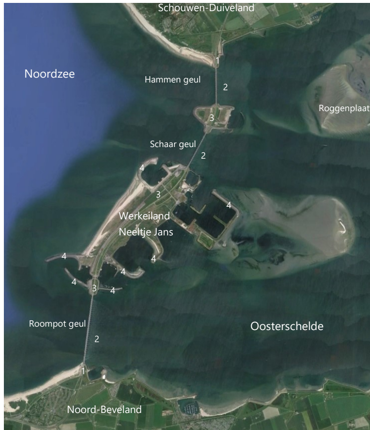
Afbeelding 2.3 Oosterscheldekering (1: damaanzetten, 2: beweegbare kering, 3: vaste kering, 4: havendammen)
